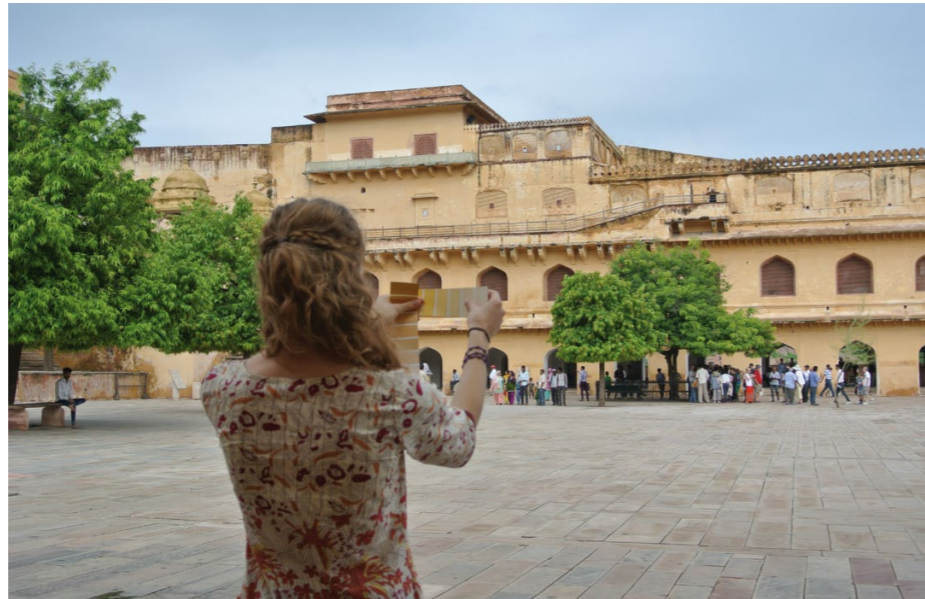
Rebecca Goodson vor dem Amer Fort in Jaipur (Indien): Das Analysieren eines Farbtons muss manchmal von der Ferne geschehen, um Fugen, etc. in den Grundfarbton der Gesamtläche optisch zu integrieren.
