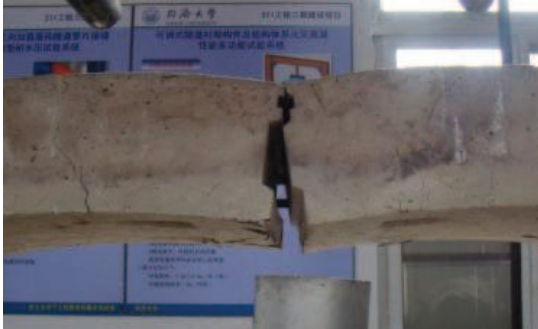
(d) Joint bolts yielding (HFRCJ2)
