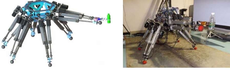
Fig. 7. Grab object using one leg.
