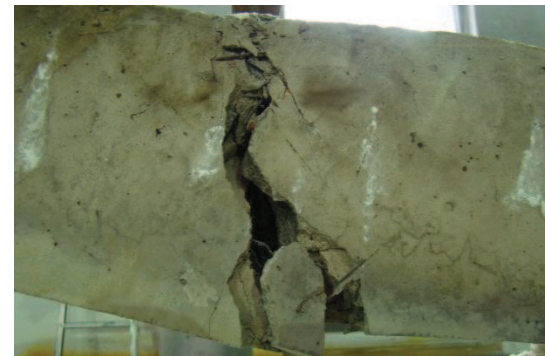
(f) Concrete fracture (HFRCJ3)
