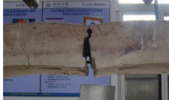
(d) Joint bolts yielding (HFRCJ2)
