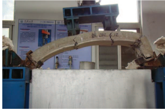
(d) HFRC6 ( P_v/R_H=1.2 , post fire )
